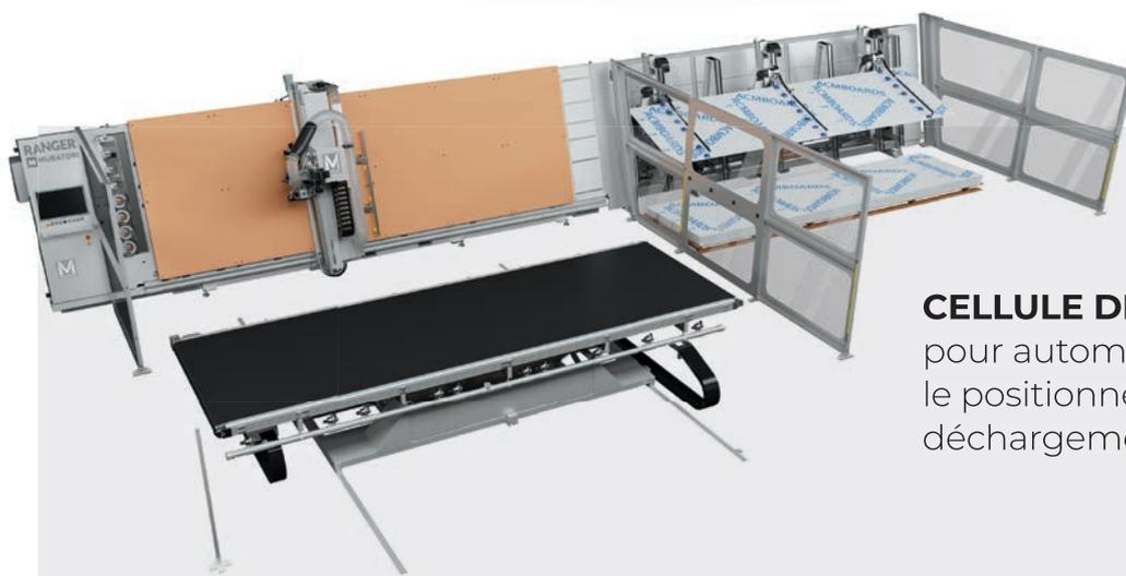
**CELLULE DE TRAVAIL INTÉGRÉE** pour automatiser le chargement, le positionnement et le déchargement des panneaux.
