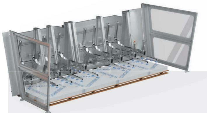
**LOADER** est le Chargeur - Positionneur pour panneaux avec des bras de levage munis de ventouses, reliés au système du vide de la CNC Ranger (breveté).
