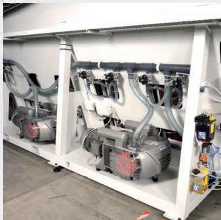
Pompes à vide intégrées dans le bâti
